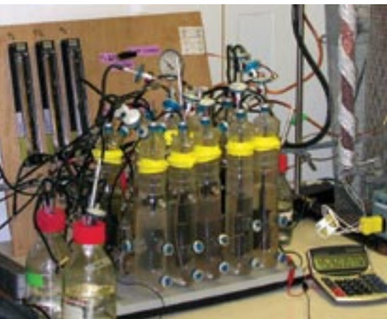
Estas celdas microbianas, conectadas como una pila, aportan la energía suficiente para hacer funcionar la calculadora.
